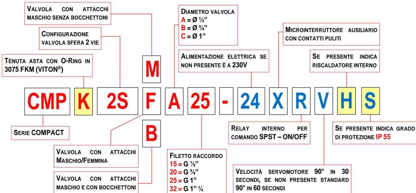
**CMP K2SC-24XRVHS** valvola sfera motorizzata Femmina-Femmina 2 vie DN 25 Ø 1" (**C**) e tenute in FKM (**K**)– servomotore reversibile con relay interno (**R**) per comando SPST, microinterruttore ausiliario con contatti puliti (**X**), Time 90° in ~ 30 secondi (**V**) completo di riscaldatore interno da 2W (**H**) come anticondensa, 24V ± 10% 50/60Hz **IP 55** (**S**).
