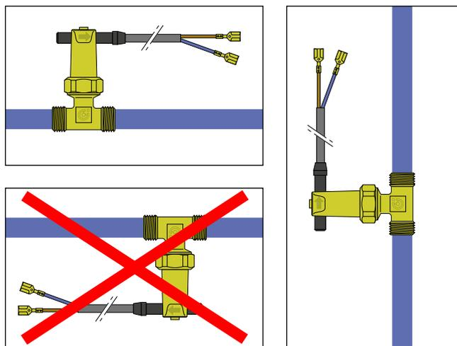
Il flussostato serie 315 può essere installato su tubazione verticale od orizzontale ma non in posizione capovolta. La parte superiore del flussostato, contenente il comando magnetico, è fissata rigidamente al corpo, pertanto non può essere rimossa.
